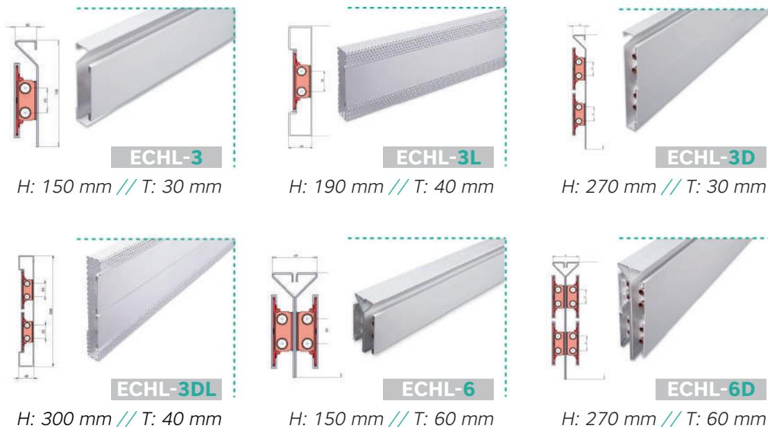
Die Sockelheizleisten werden in sechs Standard-Profilformen geliefert und haben bei einer Höhe von 150 – 300 mm eine Tiefe von 30 – 60 mm. Alle elektrischen Sockelheizleisten werden fertig verkabelt und steckfertig geliefert.
